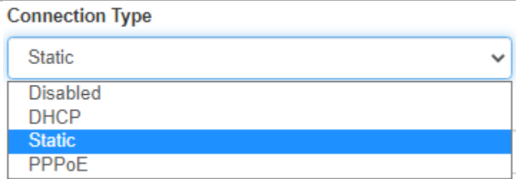
Рис. 10. Тип соединения для WAN-порта
