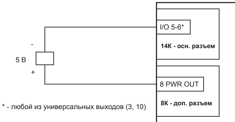
Рис. 3.12. Схема подключения реле к выходу (5 В)
